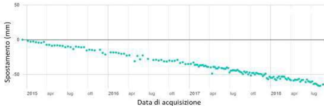
Figura 18 – Esempio di serie temporale di deformazione. In ascissa la data di acquisizione, in ordinata lo spostamento registrato in millimetri.
